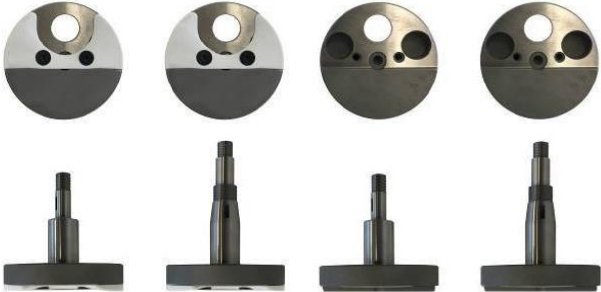
FOTOGRAFIE VILBROCHEN CU INDICAREA MASELOR PENTRU ECHILIBRARE PICTURE OF CRANKSHAFT WITH THE BALANCER
